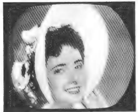
Bild 6. Durch einen periodischen Störer verursachtes Leuchtdichtemöiré als Schwarzweißbild empfangen. Die Störschwingung liegt etwa 1,0 MHz oberhalb des Bildträgers
