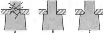
**Bild 4. Schnitt durch die Maske in der Ebene eines Loches in Bildschirmmitte. Bei schräg auftreffendem Elektronenstrahl an den Bildrändern sind die Verhältnisse bei einem zylindrischen Loch noch ungünstiger; a = Entstehung von Streuelektroden bei zylindrischem Loch, b = ideale, konische Lochform, c = durch Ätzung erreichte, angenähert konische Lochform**
