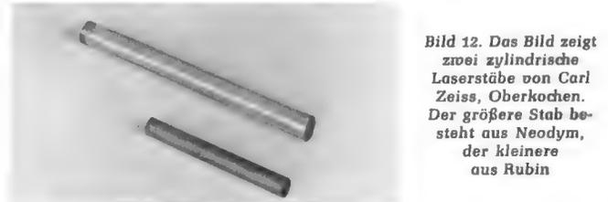
Bild 12. Das Bild zeigt zwei zylindrische Laserstäbe von Carl Zeiss, Oberkochen. Der größere Stab besteht aus Neodym, der kleinere aus Rubin
